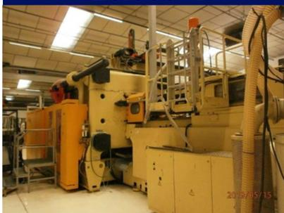
**Inyectora termoplástico 1350 ton, con robot**
