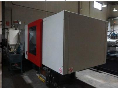
**Inyectora termoplástico 200 ton.**
