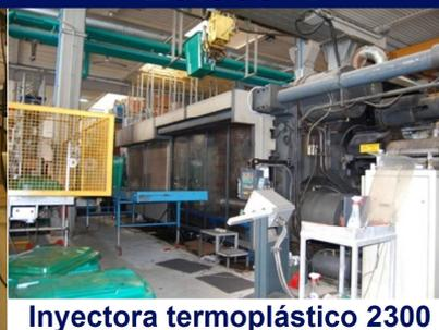
**Inyectora termoplástico 2300 ton. Robot Dalmaschio.**
