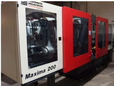
**Inyectora termoplástico 200 ton. doble bomba**
