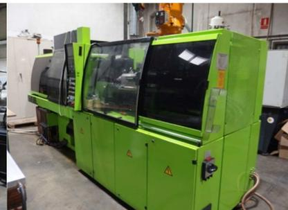
**Inyectora termoplástico 70 ton.**
